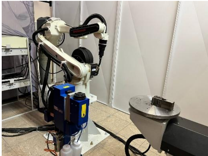
Роботизированная установка электродугового выращивания WAAM на базе промышленного робота-манипулятора Kawasaki
