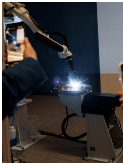
Роботизированная установка электродугового выращивания WAAM на базе промышленного робота-манипулятора Kawasaki
