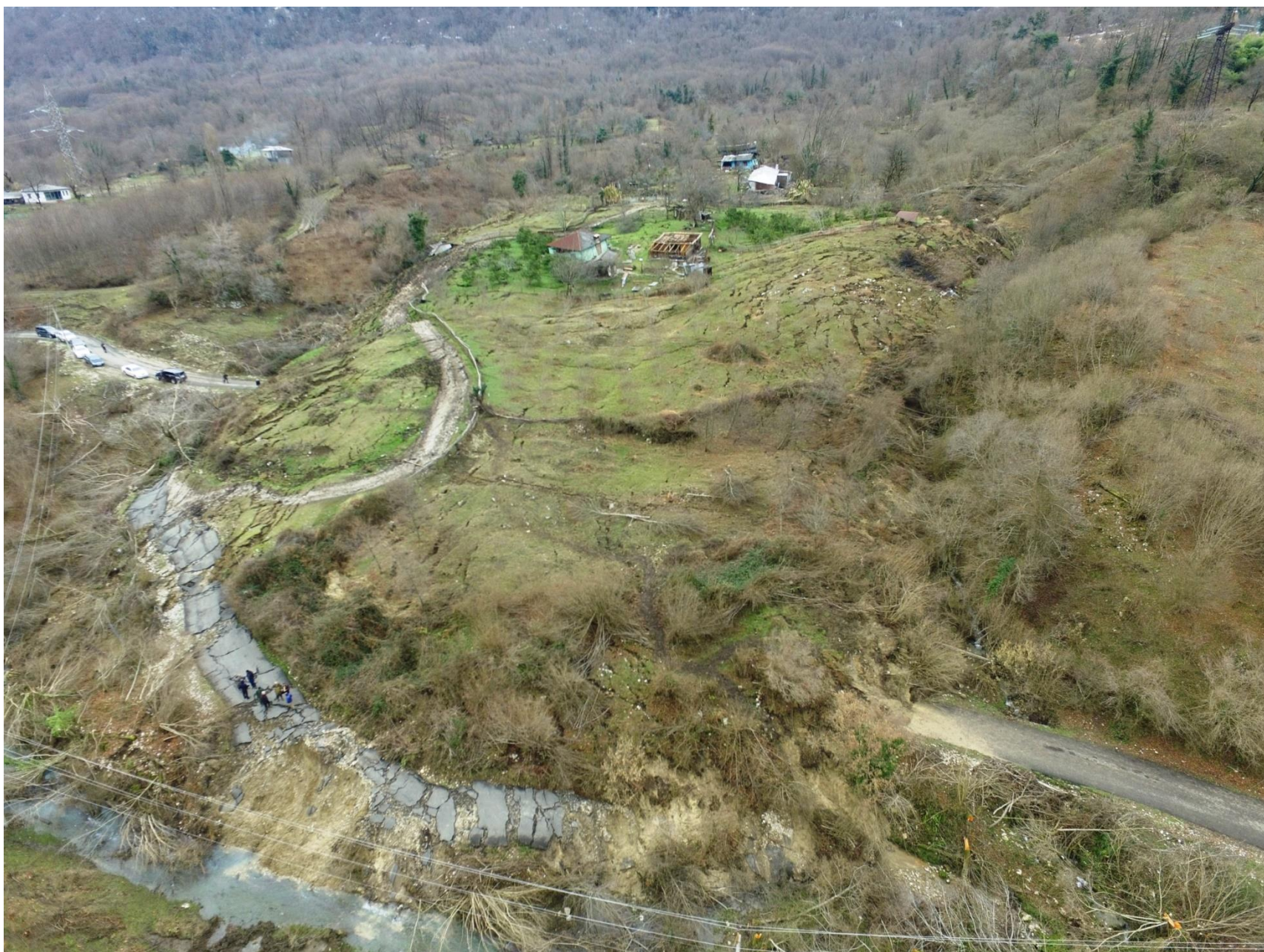
Оползень между Очамчиры и Ткварчели. 2020г. Дождь, таяние снега, крупный блочный оползень смещает балочные отложения, уничтожены дома, дорога.
