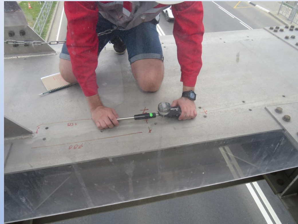
Снятие показаний с помощью электронного деформометра
