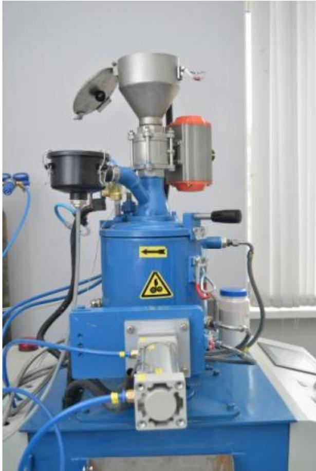
Прежде чем новая бондирующая краска приобретет статус серийного продукта, она проходит стадию разработки в Центре разработок PRIMATEK. Компанией была приобретена лабораторная установка для бондирования порошковых красок. Она позволяет в кратчайшие сроки разрабатывать новые виды металлик BONDALUX, тестировать новые оригинальные металлические пигменты, создавать новые эффекты для удовлетворения любой дизайнерской идеи наших клиентов.
