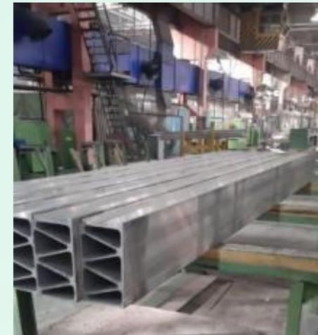
Производство ортотропной плиты из отдельных элементов с применением сварки трением с перемешиванием на ЗАО «Сеспель»
