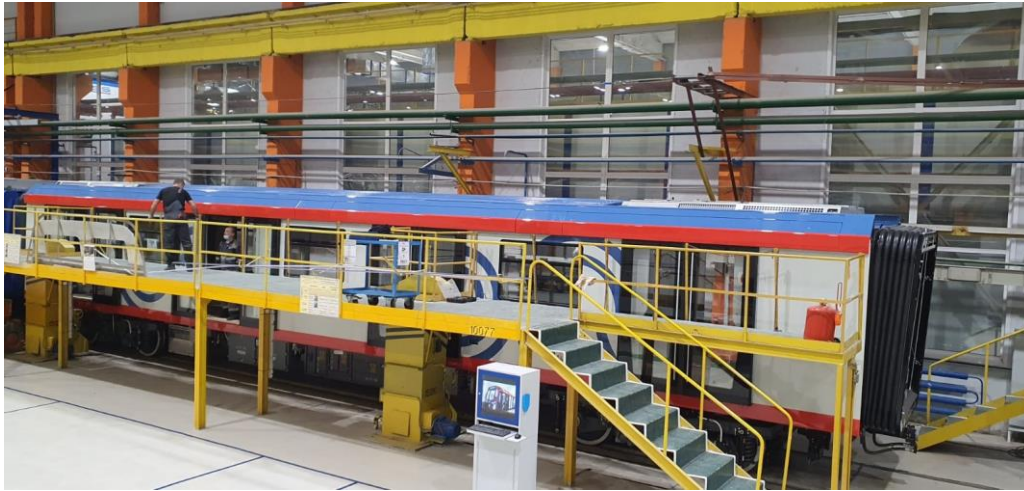
Рис. 2. Кожуха наружные из алюминиевого профиля (четкая линия)
