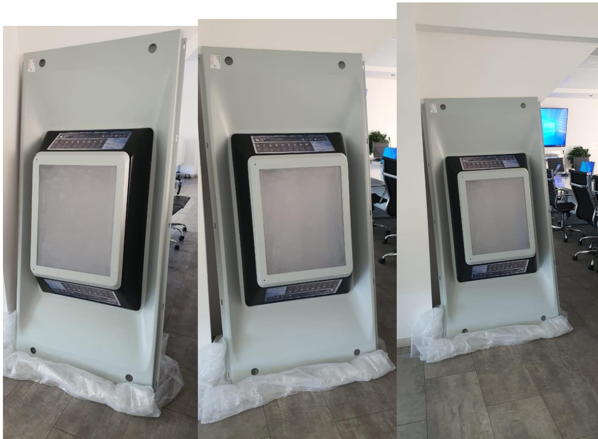
Рис. 4 Панель мониторов 3D из алюминия – глубокая вытяжка (штамп).
