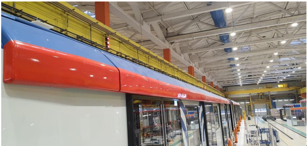
Рис. 3 кожуха из пластика (неровность поверхности)
