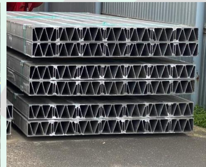
Производство ортотропной плиты из отдельных элементов с применением сварки трением с перемешиванием на ЗАО «Сеспель»
