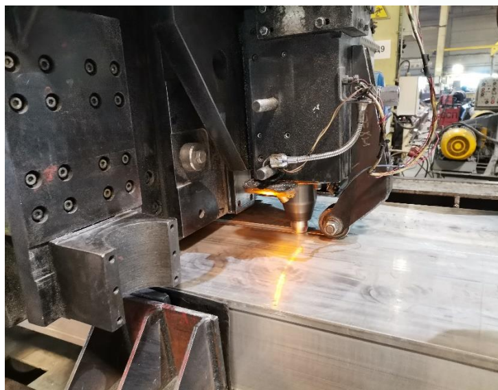
Производство ортотропной плиты из отдельных элементов с применением сварки трением с перемешиванием на ЗАО «Сеспель»
