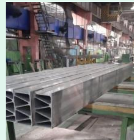
Изготовление экструдированного профиля на Красноярском металлургическом заводе (ООО КРАМЗ)
