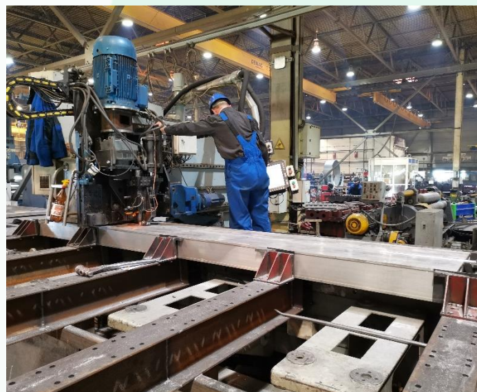
Производство ортотропной плиты из отдельных элементов с применением сварки трением с перемешиванием на ЗАО «Сеспель»
