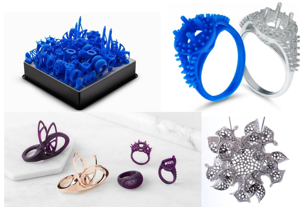
Применение АТ для изготовления газифицируемых и мастер-моделей в ювелирном производстве
