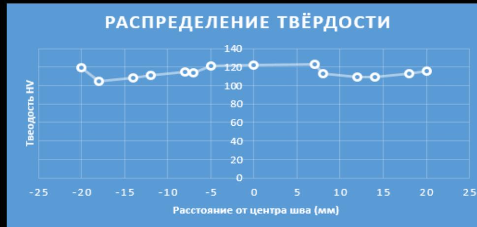
Распределение твёрдости, соответствующей линии А
