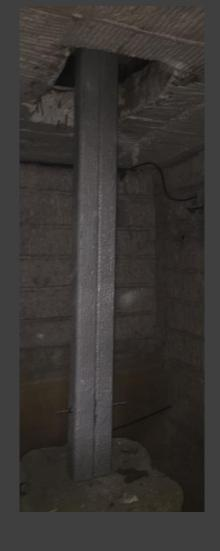
Колонна, состоящая из двух металлических труб сечением 120x120x6 мм и высотой 2952 мм, соединенных между собой резьбовой шпилькой М20. По торцам к стойке приварено 4 листа размерами 120x120 мм и толщиной 6 мм. С внешней стороны Образец покрыт огнезащитным покрытием
