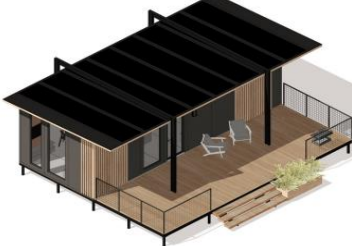
ПОДВЕСНАЯ КРЫША С СОЛНЕЧНЫМИ ПАНЕЛЯМИ
