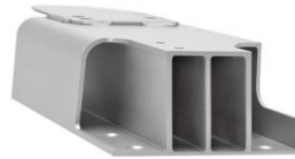
Пространственная рама кузова из алюминиевого профиля
