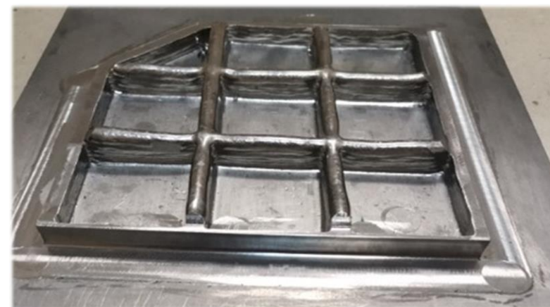
Фотография частично обработанного макета изделия «сотовая панель» (Материал – ВТ6ч)
