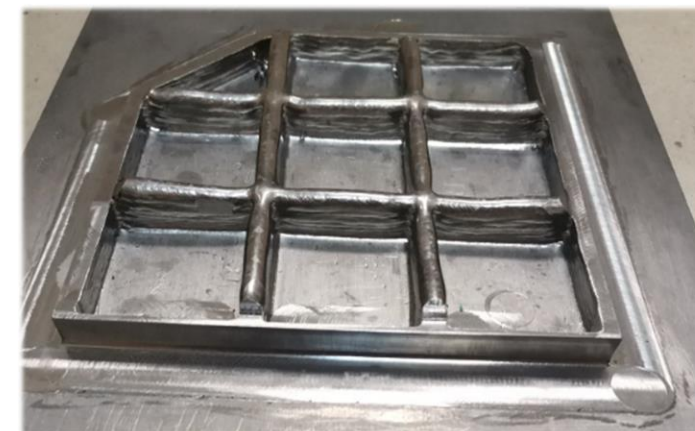
Фотография частично обработанного макета изделия «сотовая панель» (Материал – ВТ6ч)
