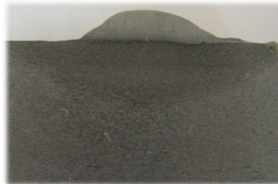
Макрошлиф наплавленного валика на токе обратной полярности
