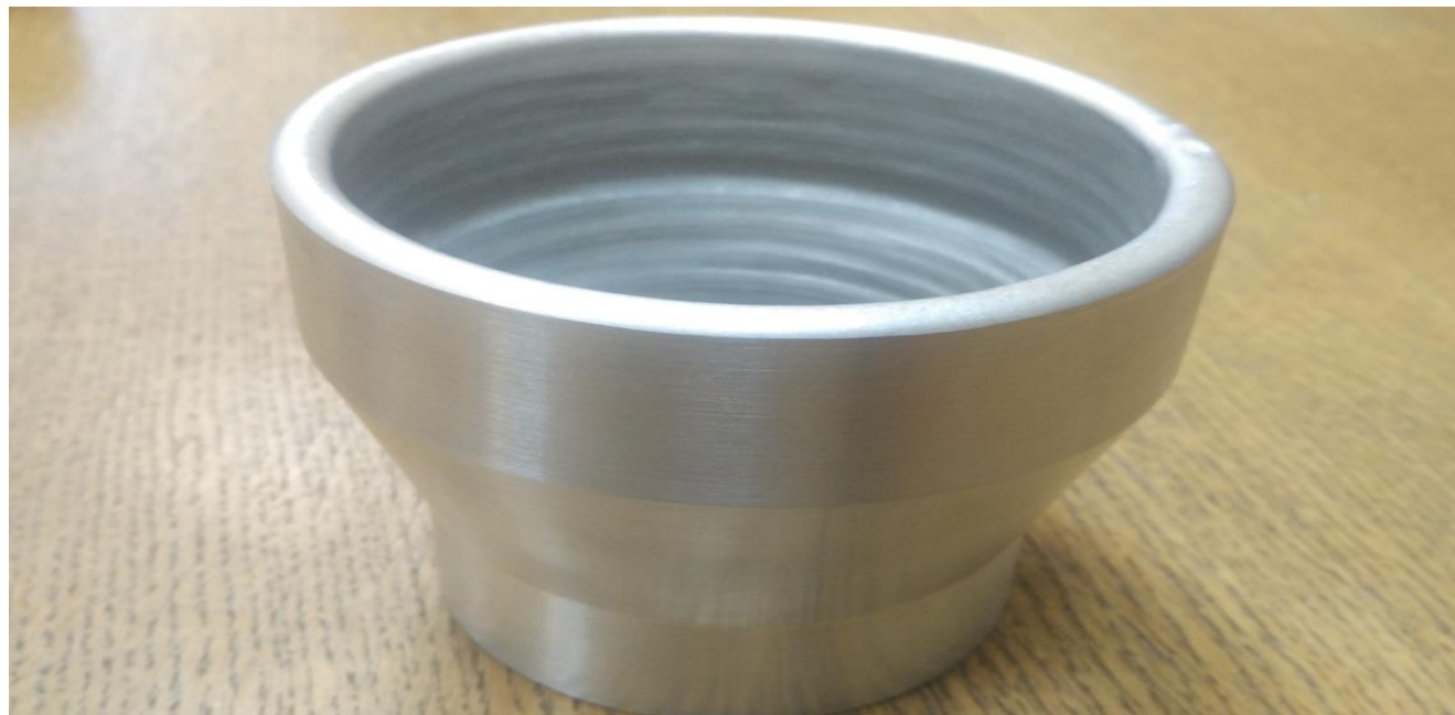
Внешний вид наплавленной детали после токарной обработки внешней поверхности
