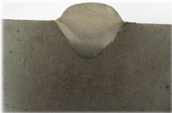
Макрошлиф наплавленного валика на токе прямой полярности
