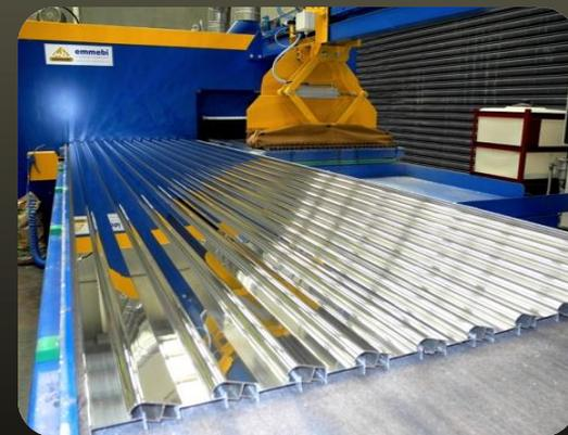
Могут быть получены различные типы отделки в зависимости от типа используемого абразивного материала и от изменения нескольких параметров обработки.
