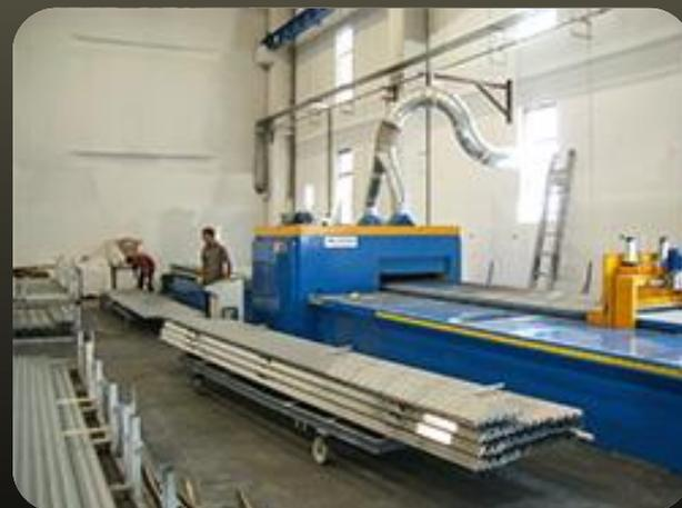
Основная особенность состоит в том, что имеется фиксированная головка, в которой для механической обработки установлены щетки из хлопка, сизаля или скотч-брайта. Головка с вертикальным перемещением, с максимальной точностью благодаря шариковому винту, обеспечивающему идеальное расположение щеток.
