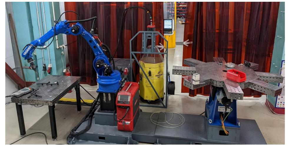
• Используемый метод печати — WAAM (wire + arc additive manufacturing, проволочно-дуговое выращивание).
