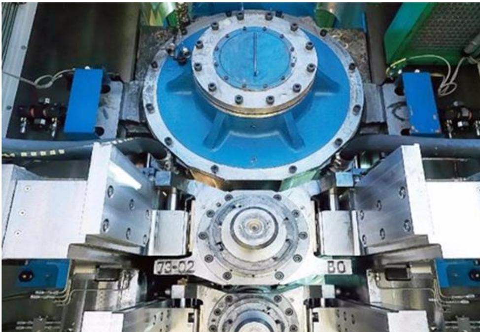
Загрязнение прокатных масел обычными гидравлическими маслами может привести к образованию пятен, которые проявятся на поверхности готового металла после отжига.
