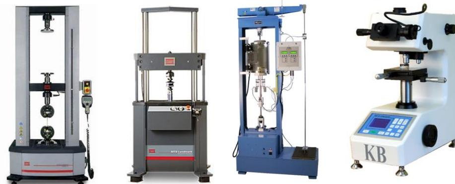
Исследования механических свойств материалов
