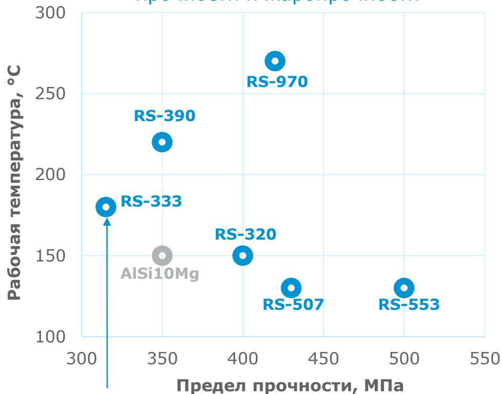
**RS-333** – сплав с повышенной на 30% теплопроводностью
