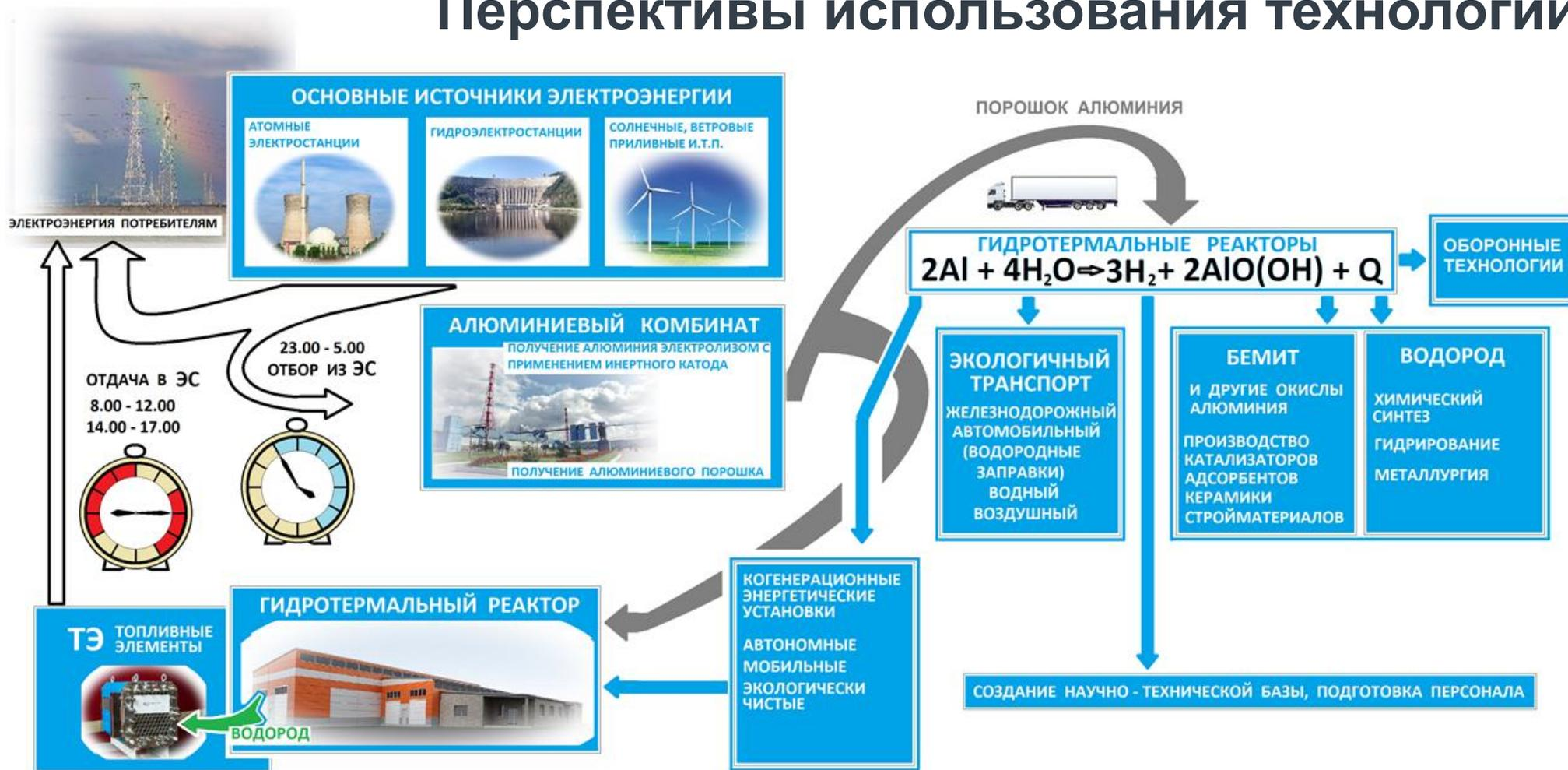
**Масштабируемая Автономная станция производства водорода** производительностью 100, 1000 м<sup>3</sup>/ч, которая позволит заправлять общественный или личный транспорт водородным топливом, улучшить экологическую обстановку.
