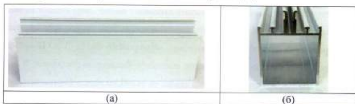
Рис.2 Внешний вид окрашенных алюминиевых профилей после испытаний в камерах сернистого газа (а) и соляного тумана (б) в течение 30 суток.
