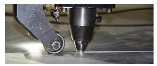
Сварка трением с перемешиванием — один из сравнительно новых видов сварки. Впервые данный способ сварки был разработан в 1991 году Британским институтом сварки. Его промышленное применение произошло только через 5 лет. На текущий момент данный вид сварки отличается высокой производительностью, но требует значительных капиталовложений. Многие эксперты полагают, что установки СТП целесообразно иметь только при большом объеме производства.
