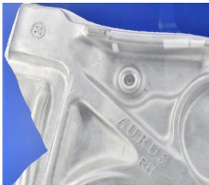
**Элементы для автомобилей семейства AURUS выполнены из отечественных алюминиевых сплавов**
