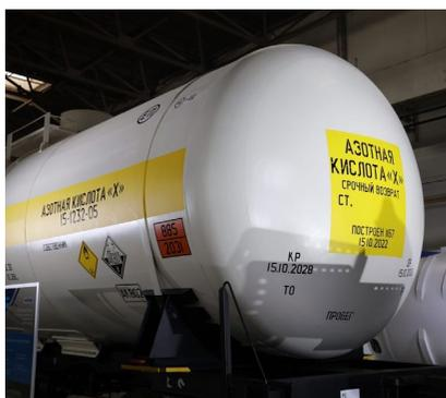
**Использование алюминия позволяет перевозить химически агрессивные грузы без риска коррозии**
