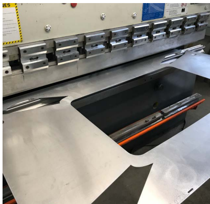
Обработка алюминиевых заготовок потолочных панелей для размещения информационных мониторов поезда «Москва-2020»
