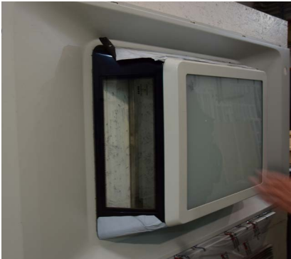
Алюминиевая потолочная панель для размещения информационного монитора в поезде «Москва-2020»
