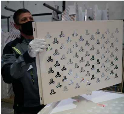
Потолочная панель из алюминия для трамвая «Львенок»
