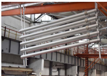
Этап анодирования алюминиевых мачт освещения
