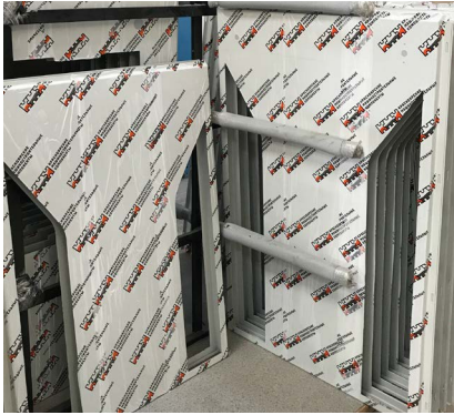
Готовые потолочные панели для поезда метро «Москва-2020» на производстве «Красноярских машиностроительных компонентов»
