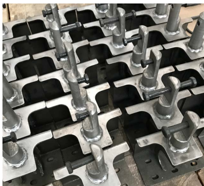
Кронштейн крепления салонных поручней трамвая Лъвёнок (ставится на придверных стойках)
