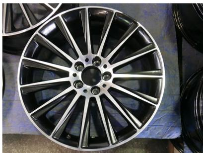
Большинство литых колесных дисков изготавливаются методом литья под низким давлением. Плотная микроструктура и высокие механические свойства достигаются за счет применения относительно низкого давления и быстрого заполнения литейной формы
