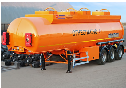
Бензовоз из сплава алюминия. Полный объем емкости - 38 м3. Делится на 4 отсека с заливными горловинами, запорной арматурой, дыхательными клапанами и др. необходимыми системами
