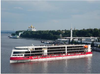
**2 круизных лайнера проекта PV-300 с алюминиевыми элементами в надстройках построено на верфях СЗ «Лотос» и СЗ «Красное Сормово»**
