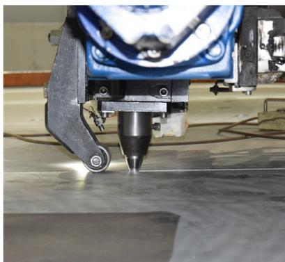
*Сварка трением с перемешиванием*
