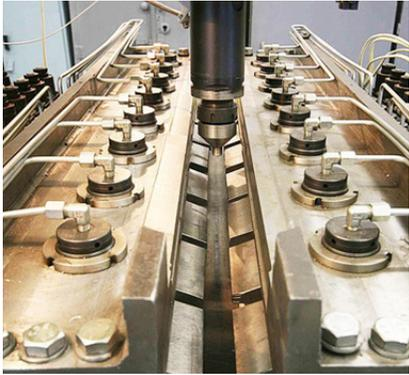
**Установка для сварки трением с перемешиванием**
