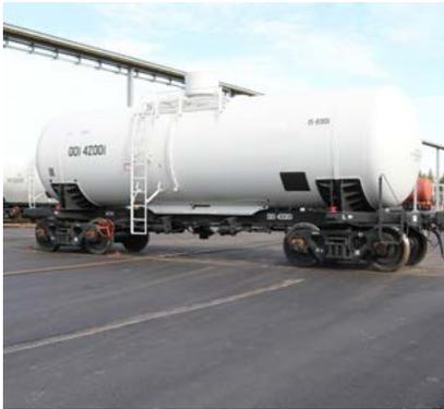
Цистерны из сплава Р-1407 могут перевозить азотную кислоту
