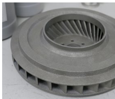
Алюминиевые детали, изготовленные при помощи 3D-печати
