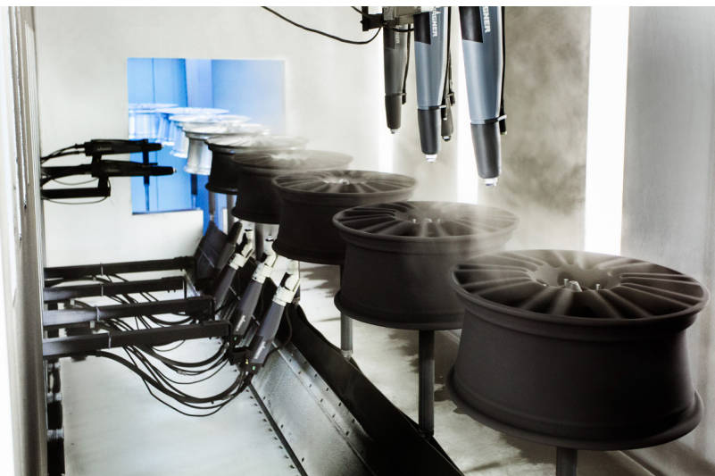
Автоматическая линия окраски колес. Камера нанесения покрасочной системы в статическом поле
