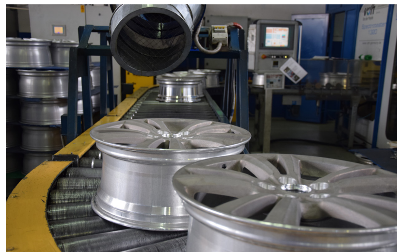
Сушка колес в процессе движения по конвейерной ленте после мойки. Мойка в производственном цикле используется для удаления СОЖ и мелкой стружки после механической обработки отливки колеса для достижения особой чистоты, необходимой на последующих производственных этапах
