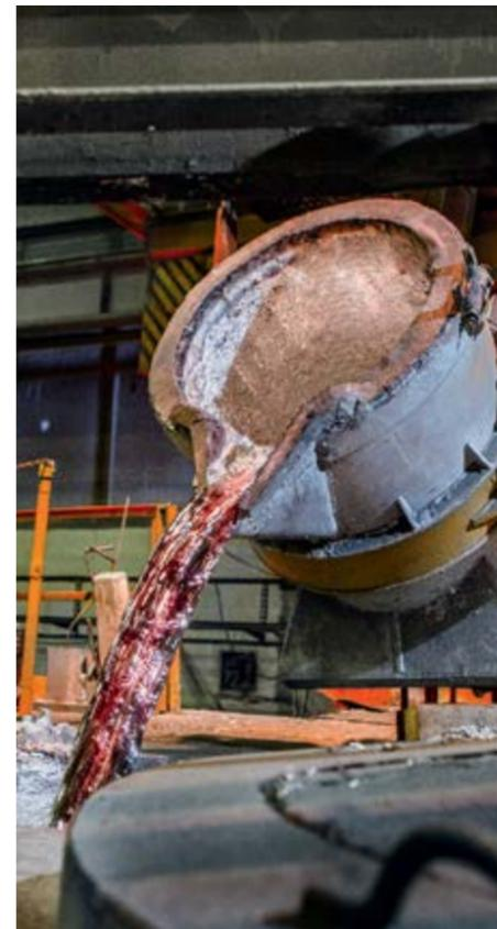
Колеса производятся по технологии литья под низким давлением
