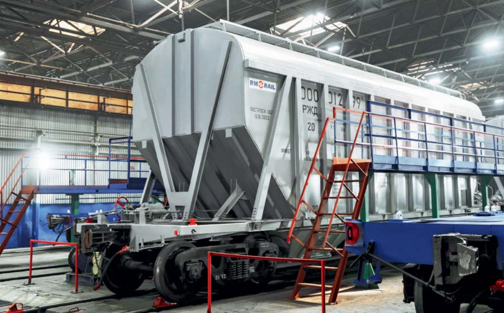
▲ Последние штрихи: вагон-хоппер модели 19-1299 из алюминиевых сплавов готов к испытаниям
