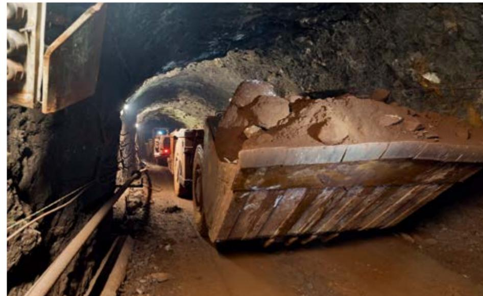
«Черемуховская-Глубокая» – еще и самая технологичная шахта, ведь, чтобы доставлять руду наверх, требуется уже совершенно новый подход, нежели в прошлом. Здесь применено нестандартное техническое решение: в одном стволе размещены сразу три подъемные машины. В целом работы в шахте автоматизированы: на объекте работают самоходные буровые установки, современные дизельные самосвалы и погрузчики, а также электровозы.
