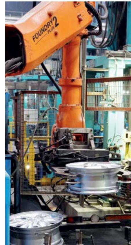
Механическая обработка готовой отливки
