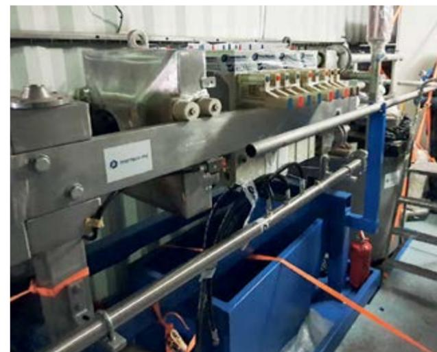
Опытная установка по высокоскоростному разделению пульпы глиноземного производства
