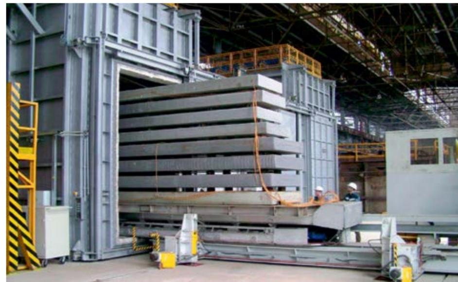
Загрузка контрольной садки в печь Secowarwick № 1 на обрабатывающем участке плавильно-литейного производства
