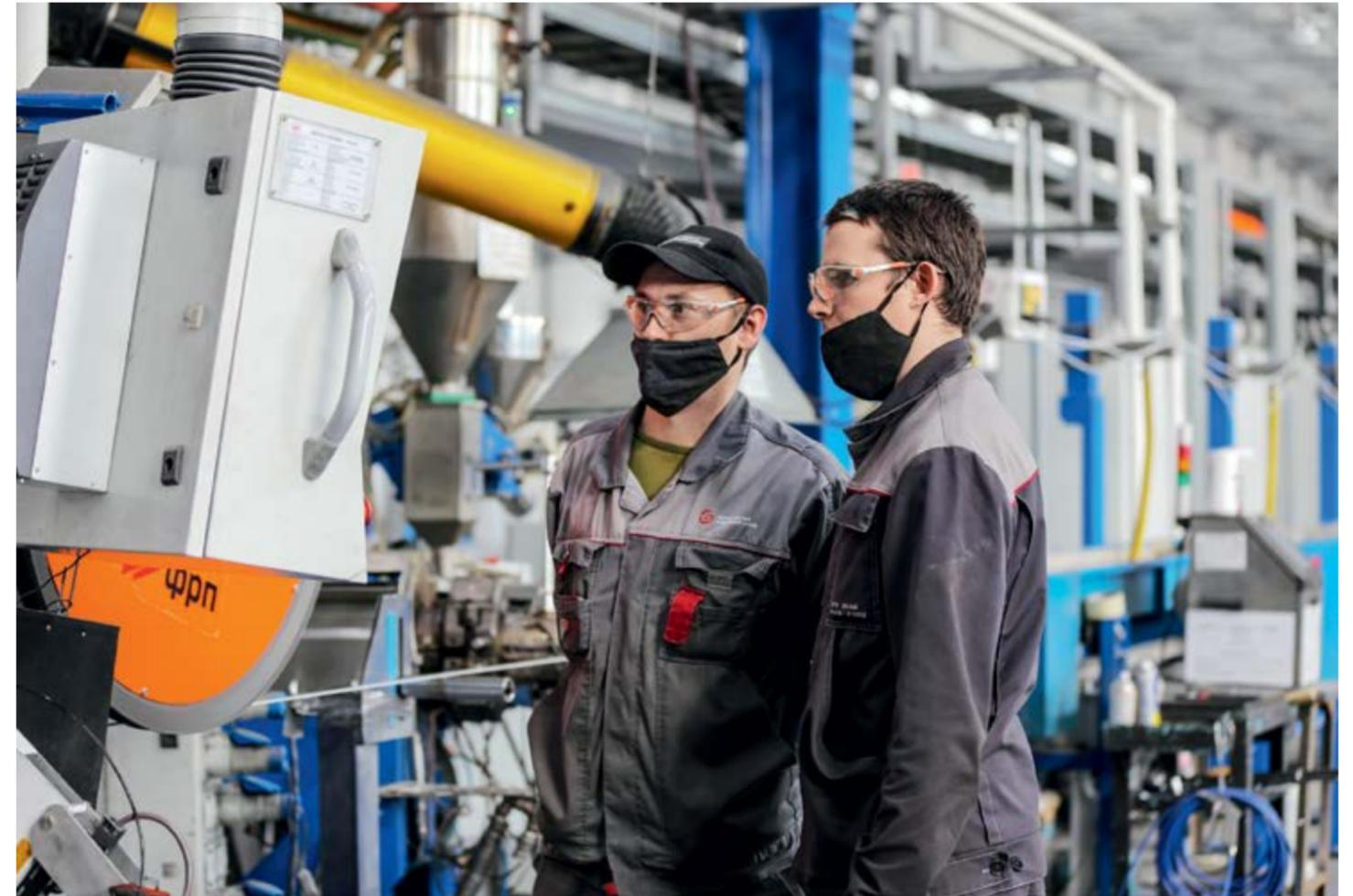
Панель оператора экструзионной линии для наложения изоляции в цехе № 2
