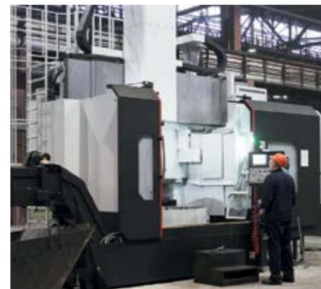
Токарно-карусельный станок с ЧПУ, предназначенный для производства штамповой оснастки с высокой точностью
