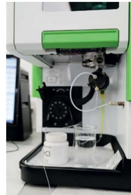
➤ АЭС-ИСП-спектрометр позволяет определять химический состав любого алюминиевого сплава
