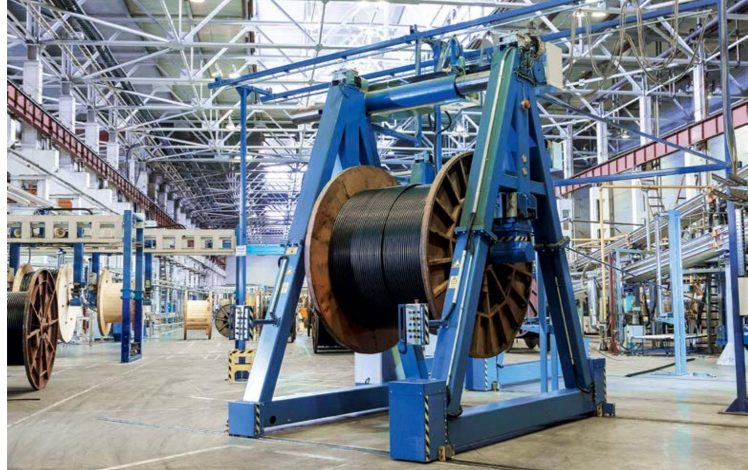
▲ Кабель в изоляции из сшитого полиэтилена
