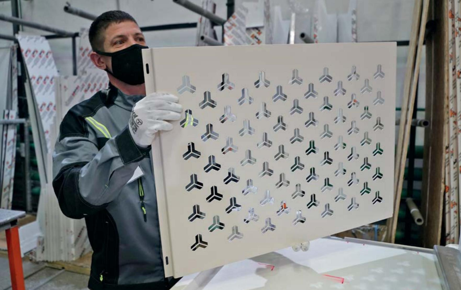
Потолочные панели трамвая 71-91ЕМ «Львенок» на производстве
