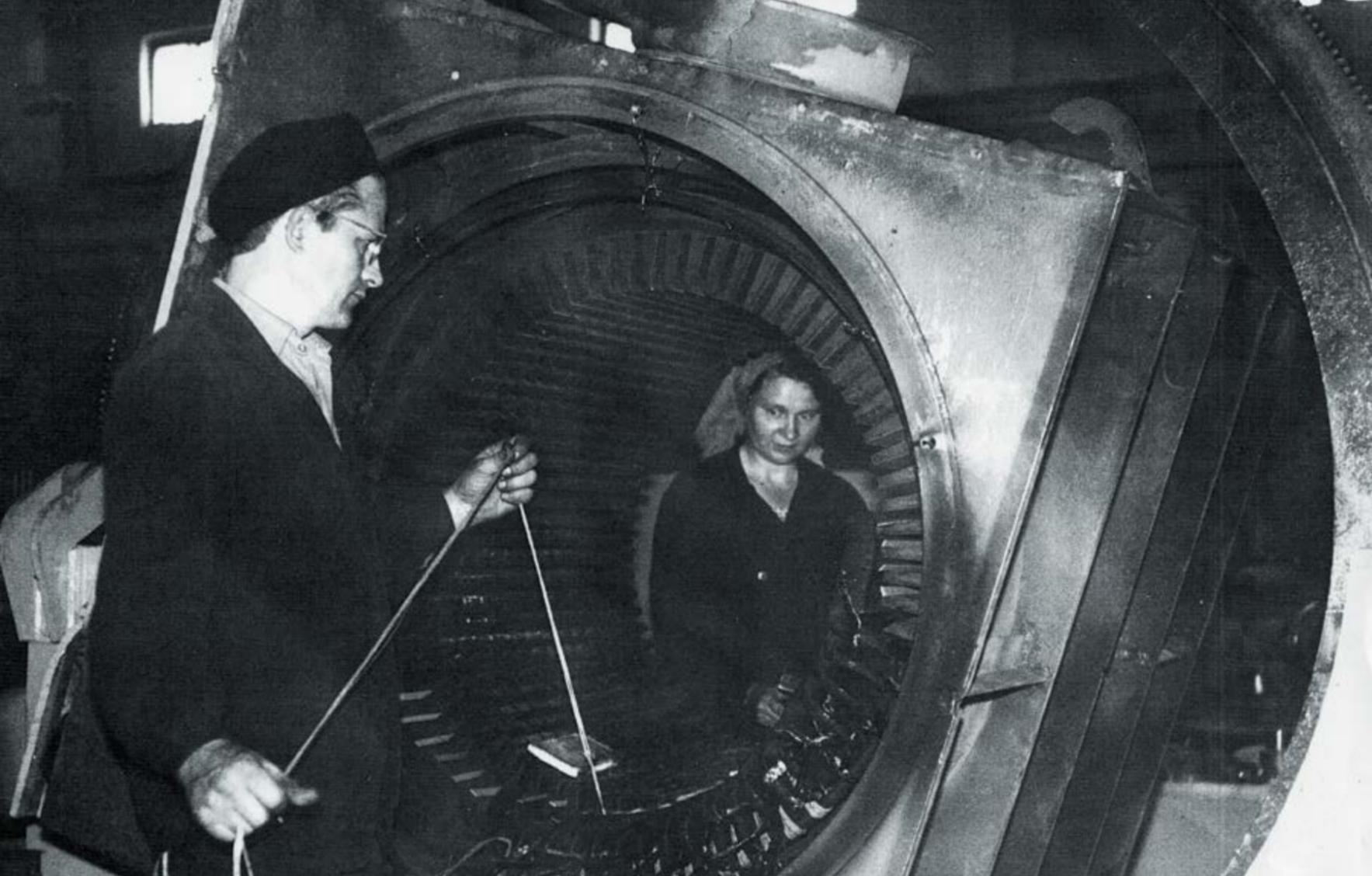
Укладка секций в статор электрического двигателя
