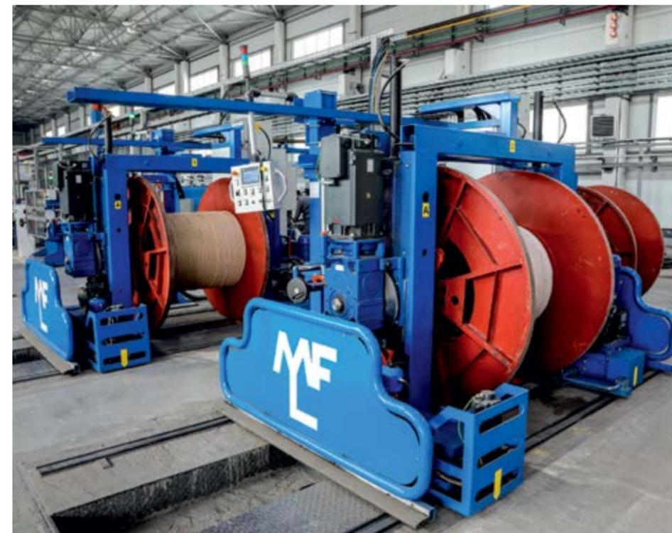
Приемные устройства экструзионной линии для наложения изоляции установлены в цехе №2
