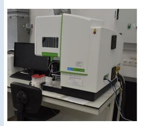
Оптико-эмиссионный искровой спектрометр **Bruker Q8 Magellan** позволяет проводить оперативный количественный анализ химического состава алюминия и алюминиевых сплавов в широком диапазоне концентраций, от долей ppm до десятков %.
