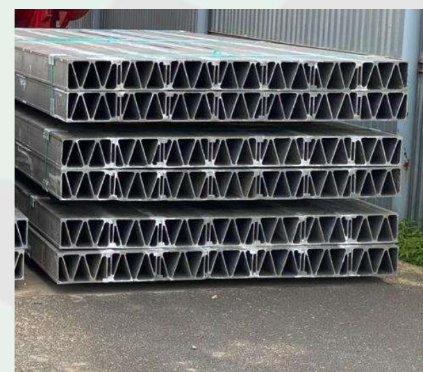
JSC 「SespeI」 での摩擦攪拌溶接を使用した個々の要素からの直交異方性板の製造
