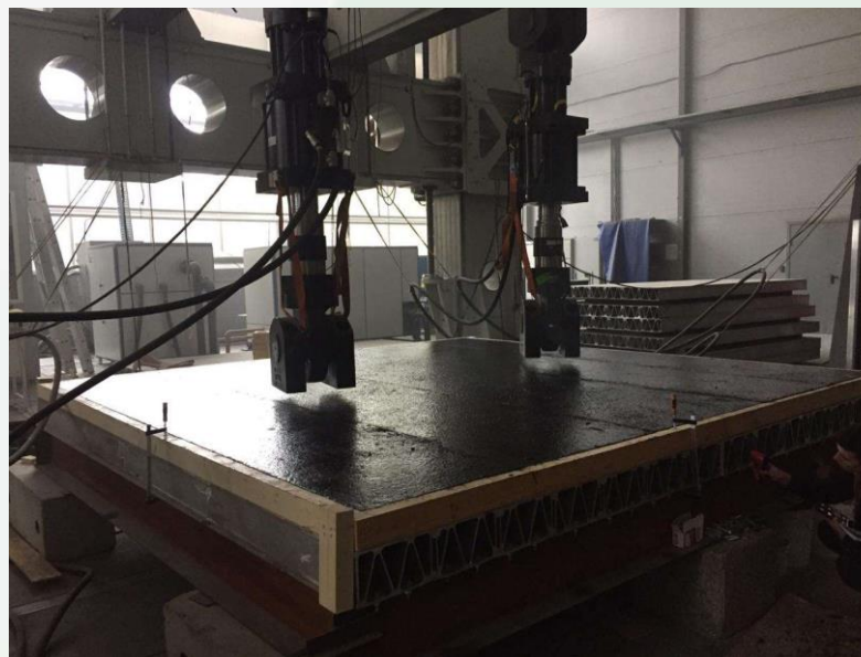
周期的衝撃に対する舗装（鋳造アスファルトコンクリートの2層表面）を備えた直交異方性版の試験
