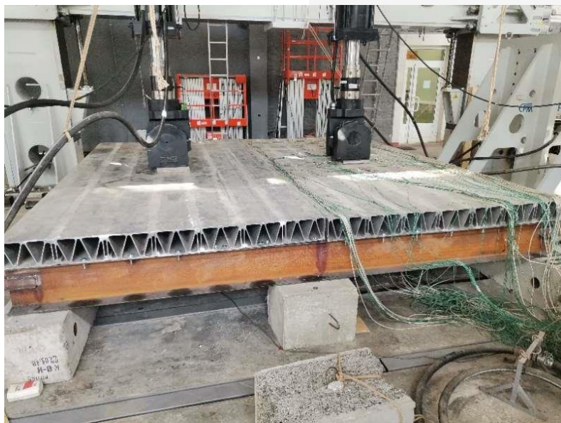
舗装なしの直交異方性版の静的衝撃の試験（負荷85トン）
