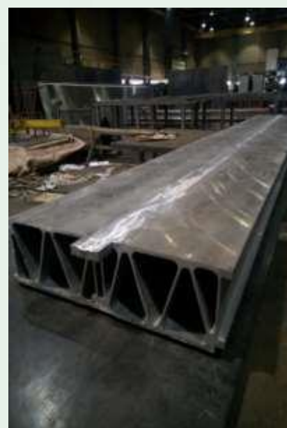
JSC 「SespeI」 での摩擦攪拌溶接を使用した個々の要素からの直交異方性板の製造
