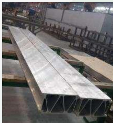
クラスノヤルスク冶金工場 (LLC KRAMZ) での押し出し型材 の製造
