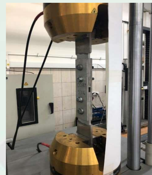
ボルト接合試験（引張強度の変化、耐食性）
