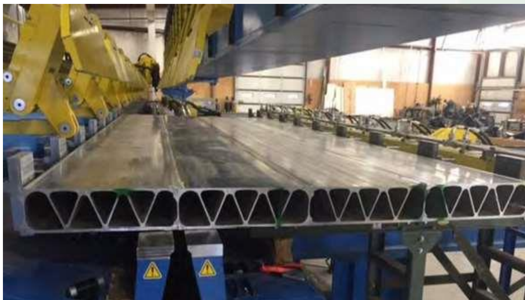
JSC 「SespeI」 での摩擦攪拌溶接を使用した個々の要素からの直交異方性板の製造
