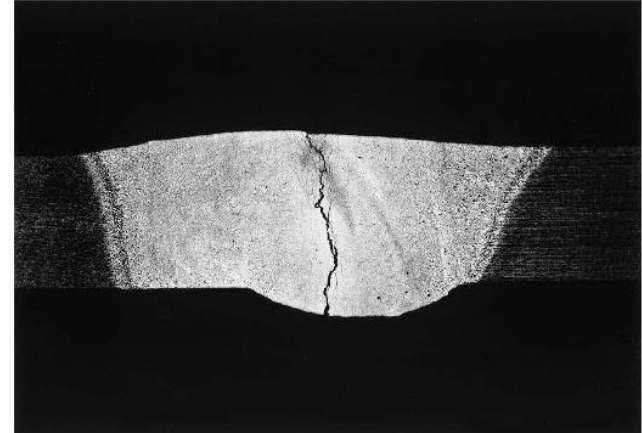
Пластина A6082 толщиной 3 мм присадочный металл 4043, TIG- сварка
