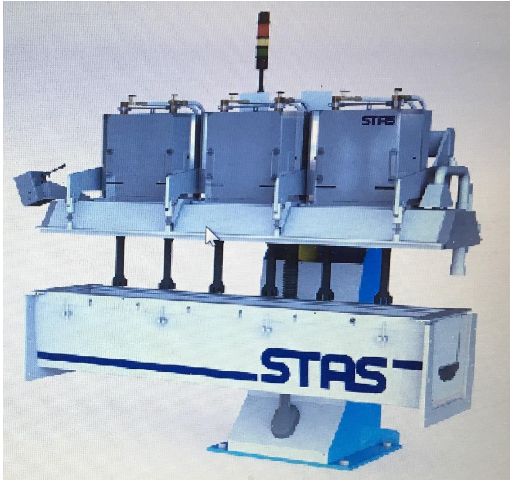
ПРИМЕР 6-ти СТУПЕНЧАТОЙ РОТОРНОЙ ДЕГАЗАЦИИ
