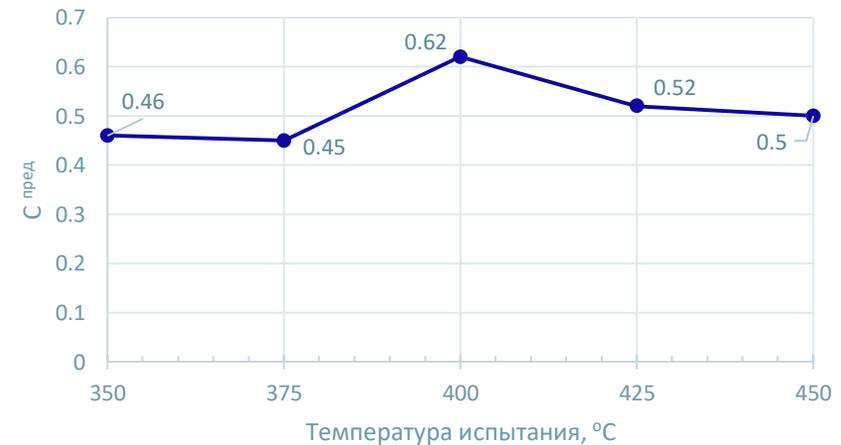
Пределное значение критерия разрушения Кокрофта-Латама в зависимости от температуры образца
