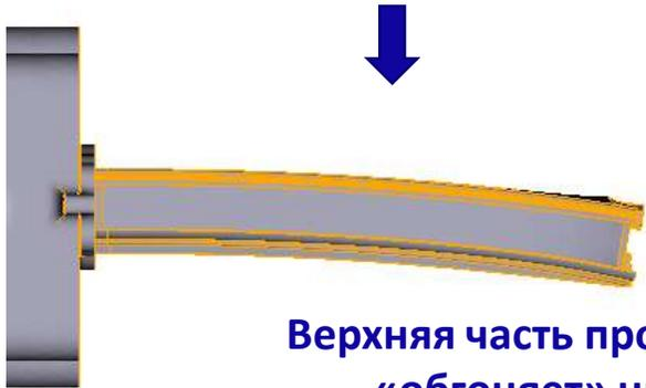
Верхняя часть профиля примерно на 2% «обгоняет» нижнюю, из-за чего происходит относительно небольшой изгиб профиля
