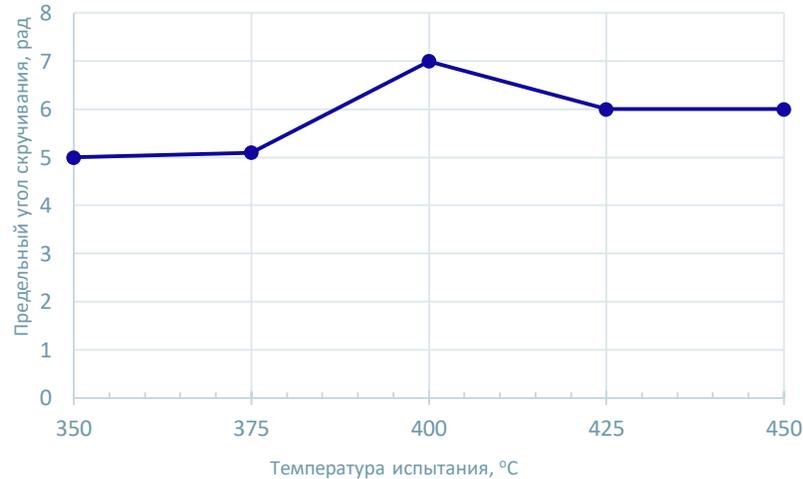
эквивалентная деформация до начала разрушения максимальна при температуре 400°C и снижается при уменьшении или увеличении температуры относительно это значения.
