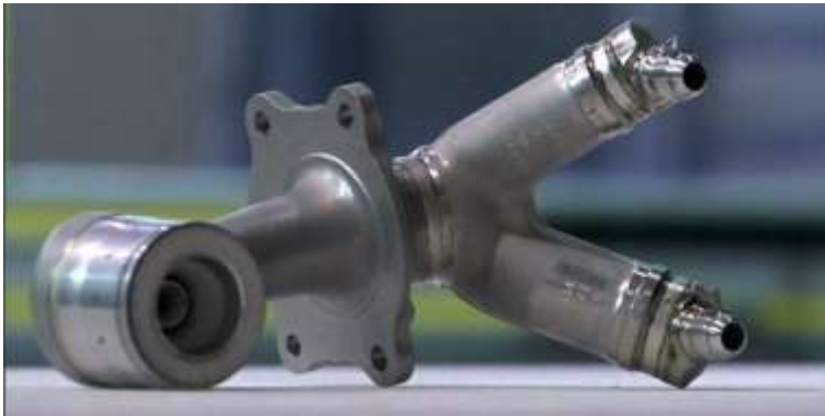
Форсунка двигателя LEAP 1A
