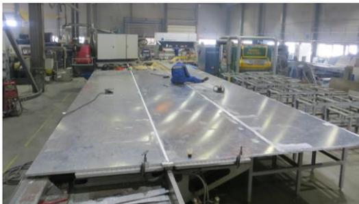
Эллиптическое днище для вагона-цистерны из алюминия АД0 толщиной 35 мм
