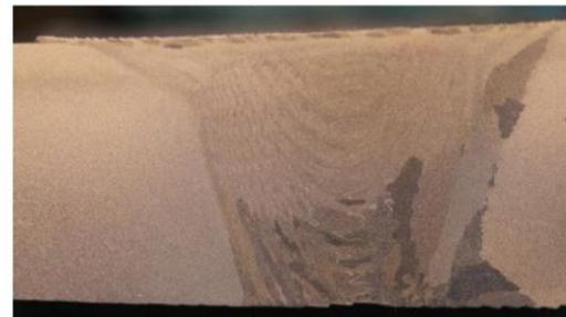
рис.1 Макроструктура сварного соединения, увеличение ~ 3,5.
