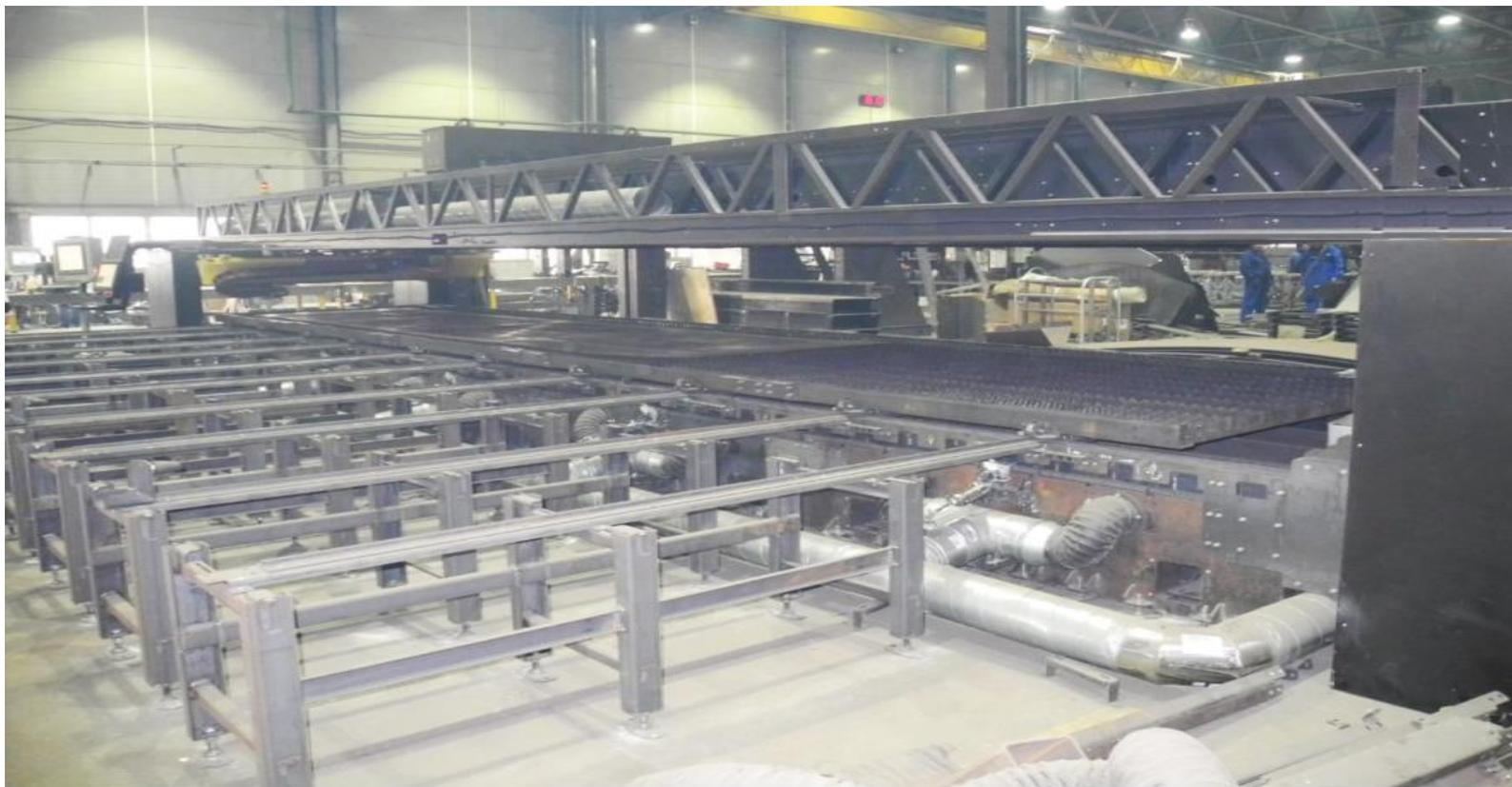
Линия лазерной сварки и раскроя «Парус» – это полуавтоматическая линия лазерной резки и сварки предназначенная для изготовления раскроя длиной 10 000 мм. Раскрой изготавливается из листового проката толщиной от 3 до 16 мм.
