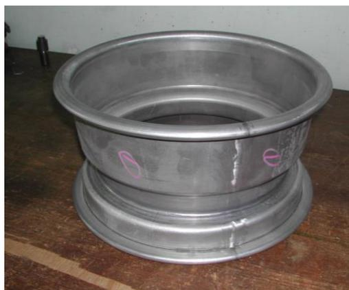
Сварка трением с перемешиванием заготовки колесного диска.
