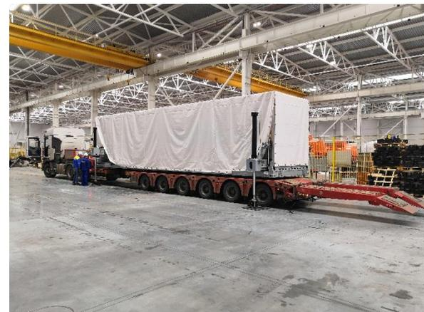
При транспортировке комплекс монтируется на передвижную платформу с помощью собственных гидравлических опор. Это позволяет оперативно использовать его на любом предприятии, а также практически снимает ограничения к габаритам выпускаемых полуфабрикатов, связанных с транспортировкой на дорогах общего пользования.
