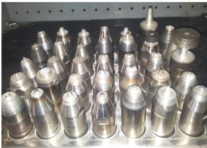
Набор сварочных инструментов СТП для AL сплавов различных марок и толщин
