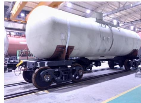
По заказу АО "ТихвинХимМаш" изготовлены и испытаны две вагон - цистерны из алюминия марки АД0 толщиной 28 мм для концентрированной азотной кислоты.
