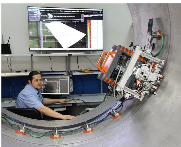
Ультразвуковой контроль сварки позволяет оператору визуально контролировать все параметры сварочного процесса на экране компьютера. Все параметры сварки также архивируются, сохраняются на твердотельном диске компьютера и доступны для проведения дальнейшего анализа.
