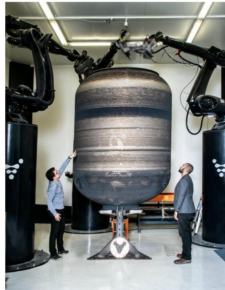
Замкнутый бак окислителя второй ступени ракеты Terran, изготовленный компанией Relativity Space (США) методом WAAM. Внутри бака выращены шпангоуты. Время выращивания около 23 суток. Материал – сплав группы Al-Mg.
