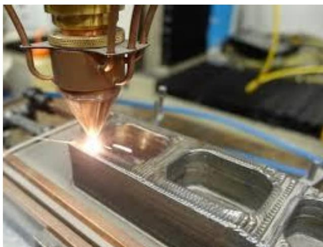
Выращивание силового кронштейна методом LDED. Материал – Cr-Ni сталь. Время выращивания – 3 часа.
