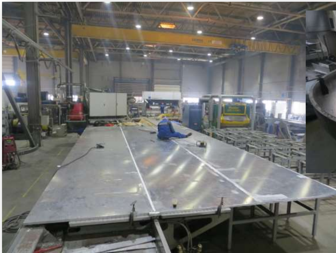
Эллиптическое днище для вагона-цистерны из алюминия АД0 толщиной 35 мм
