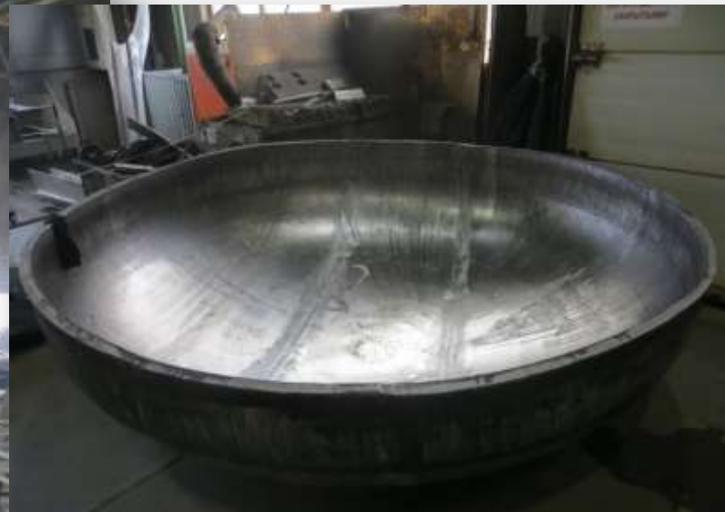
Эллиптическое днище для вагона-цистерны из алюминия АД0 толщиной 35 мм
