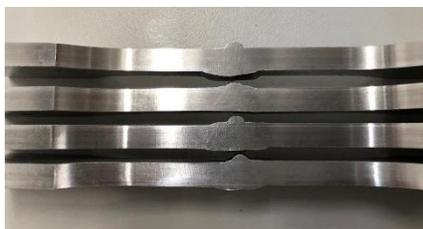
Образцы сварных соединений
