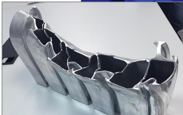
Искривление профиля вследствие неравномерности скоростей истечения
