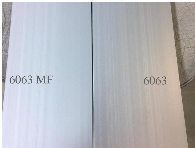
Уровень механических свойств значительно выше минимальных значений, коррозионные свойства на уровне стандартного сплава 6063.
