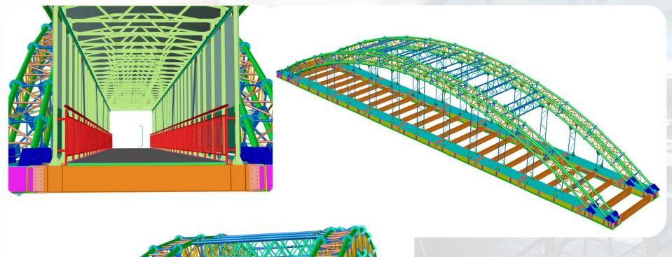
создание 3D модели и расчет элементов пролетного строения
