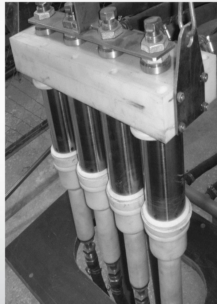
Технологический участок МДО и оснастка для оксидирования блоков цилиндров
