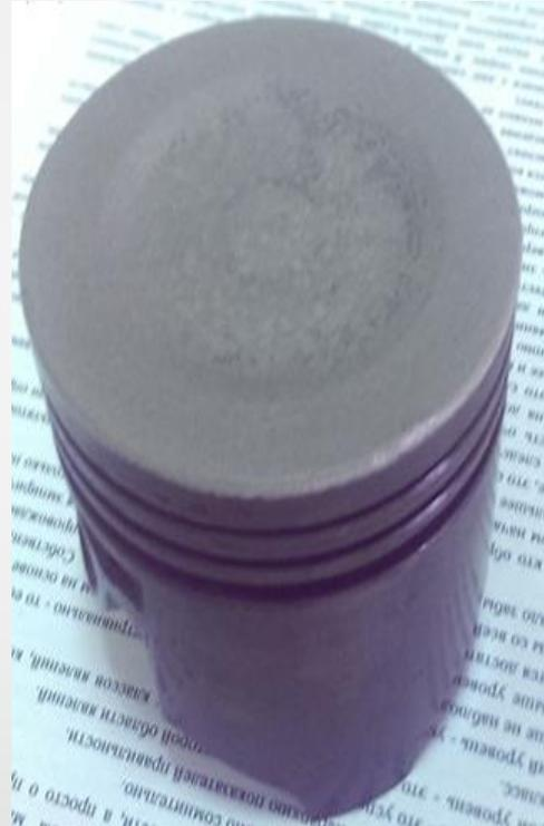
Поршень для двигателя ВАЗ с упрочняющим термобарьерным покрытием
