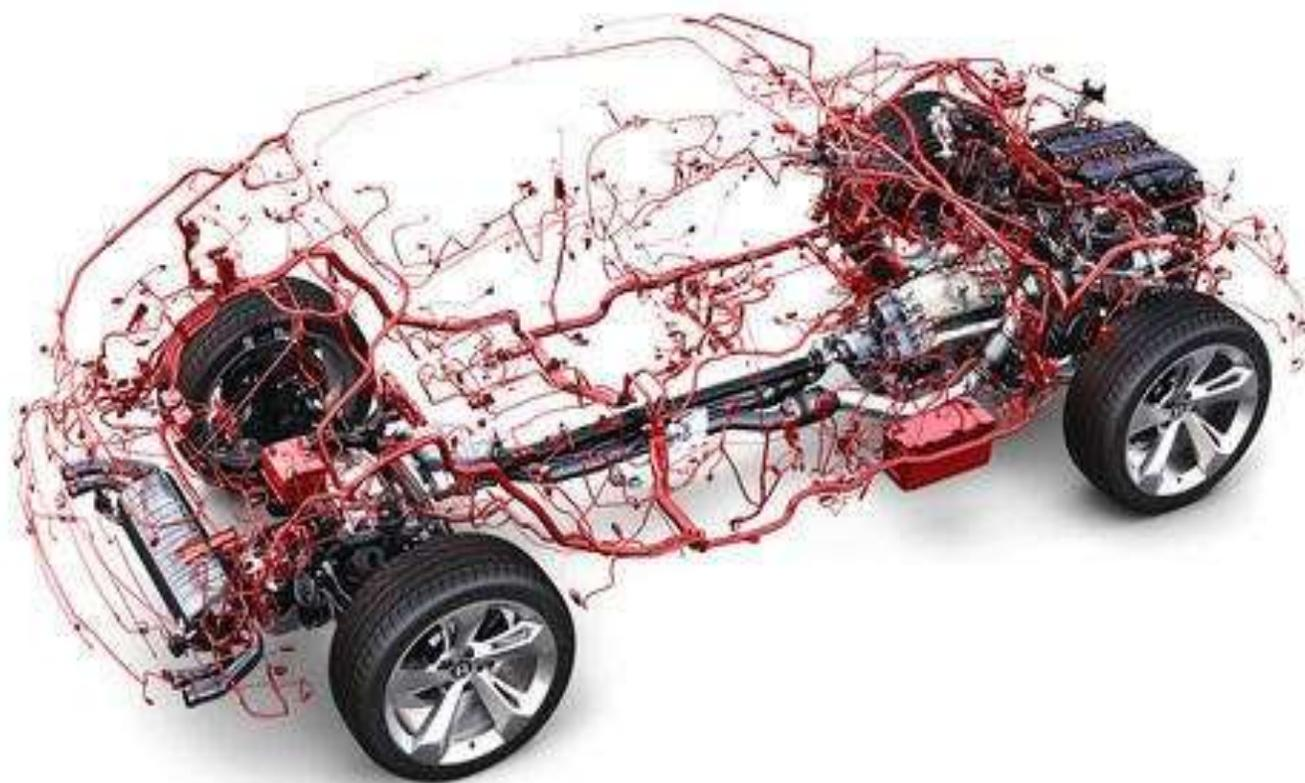
«В течение почти пятнадцати лет в автомобилях **корпорации General Motors** в силовых жгутах и используется одножильный алюминиевый провод и алюминиевый провод с медным покрытием (ССА).
