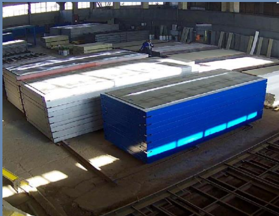
Элементы модулей заводской готовности (панели пола, перекрытий и колонны) на складе
