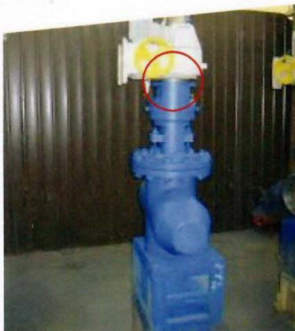
Покрытие Thixorion<sup>®</sup> наносилось на стальной вал клапана запорной арматуры, работающего в паре трения с графитовой втулкой.
